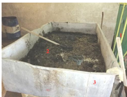
Рисунок 2. Емкость для изготовления жидкой биомассы для загрузки в биореактор 1 – биореактор, 2- биомасса для загрузки в биореактор, 3 – емкость
