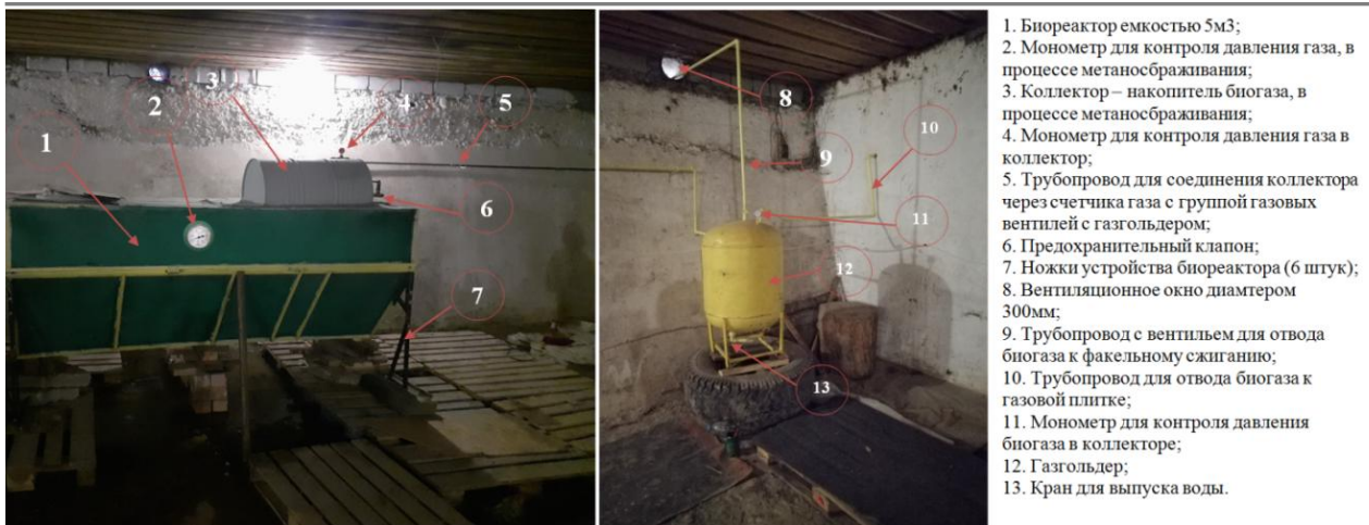
Рисунок 7 – Технологическая схема отвода и контроля физических параметров биогаза в процессе метаносбраживания (После реставрации и совершенствования в целом устройства)
