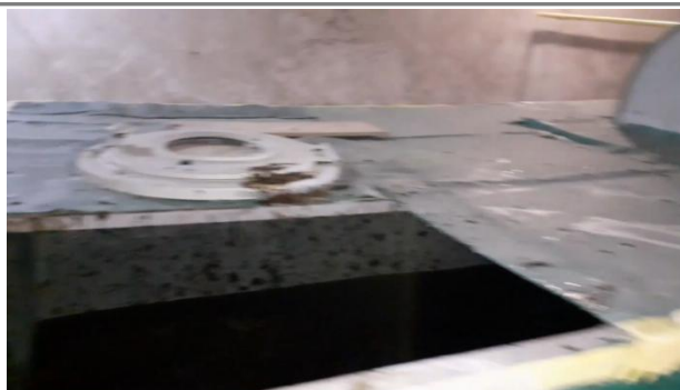
Рисунок 12. Загрузка жидкой смеси после подготовки биомассы (50*50%)
