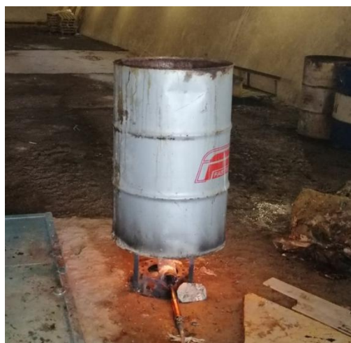
Рисунок 11. Подогрев навозной жидкости до температуры 80 0 С
